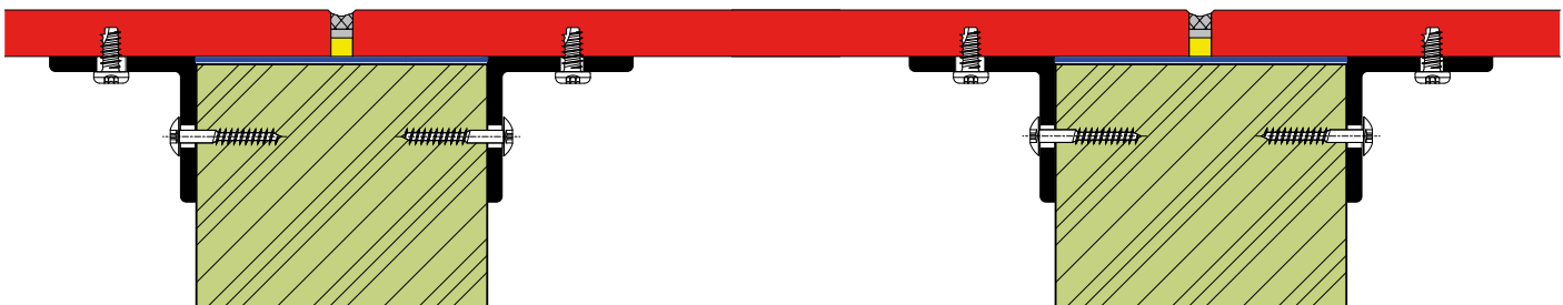
PLACA PARA SUELOS DE BALCONES EN VIGA DE MADERA CON FIJACIÓN OCULTA (ATORNILLADA)
